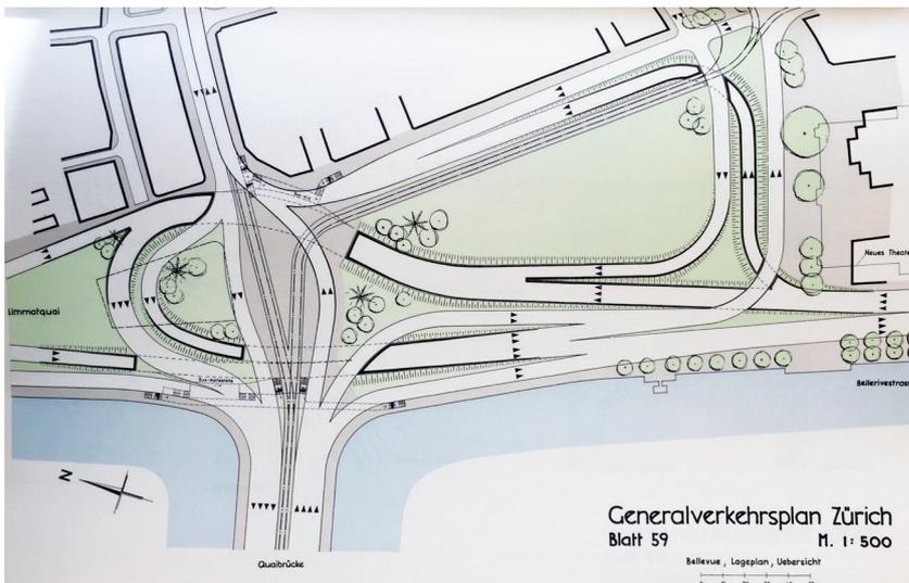
Abb. 17: Detailplan aus dem Generalverkehrsplan von Kremer/Leibbrand über die Neugestaltung des Bellevues mit dem Sechseläutenplatz.
