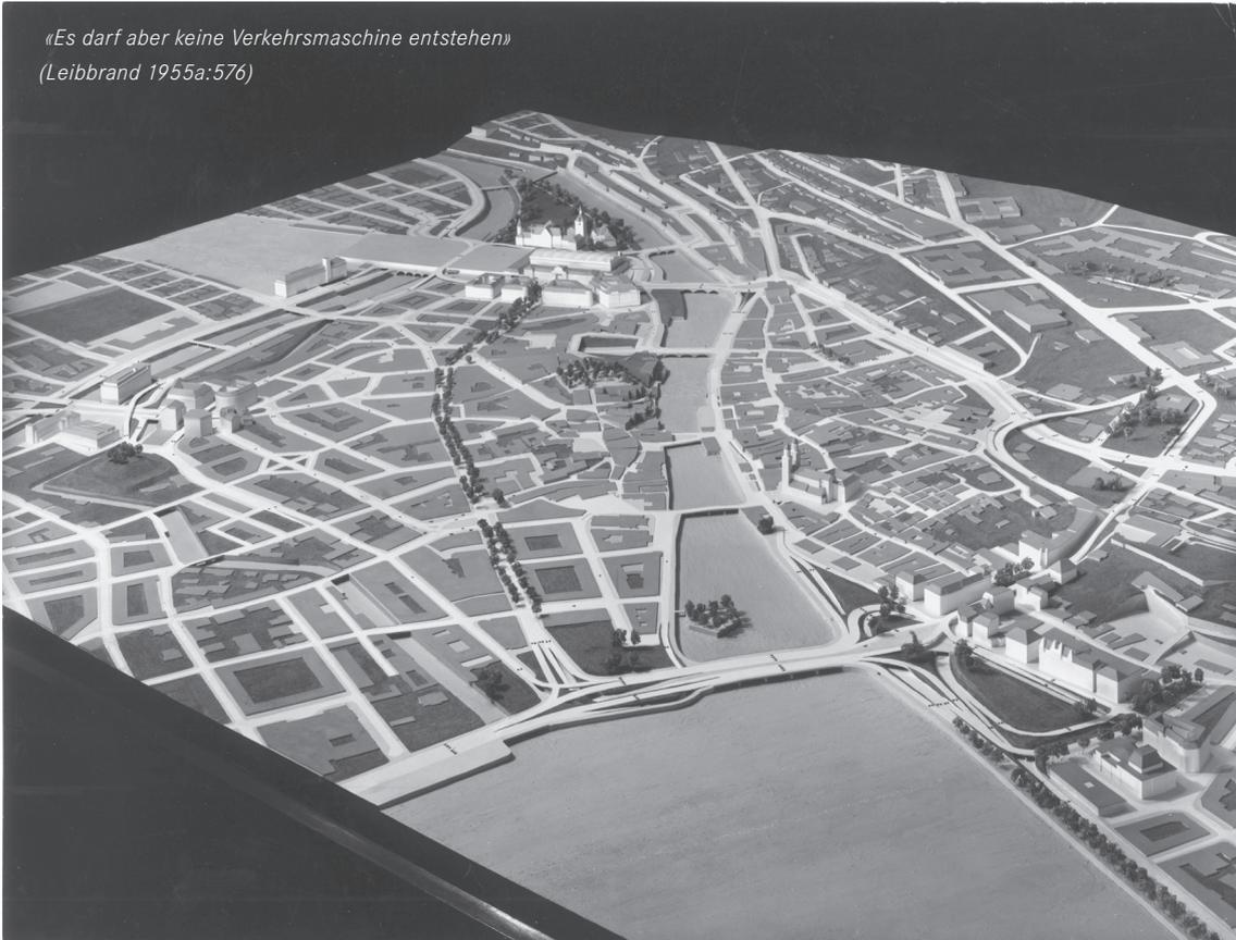
Abb. 16: Modellfoto des Generalverkehrsplan in der Innenstadt, Ansicht Zürichseebecken, von Süden. Im Bereich des Bürkliplatzes und des Bellevues ist die Stärke des Eingriffs anhand der mehrspurigen Strassen auf unterschiedlichen Niveaus zu erkennen.
