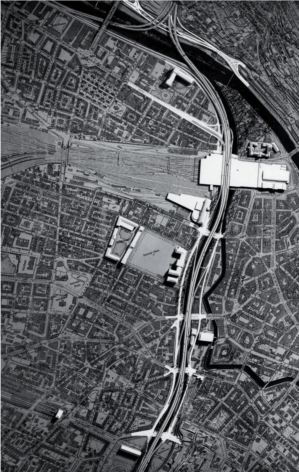
Abb. 26: Modellfoto der Sihlhochstrasse Abschnitt Sihlhölzli – Milchbucktunnel, 1959. Die Expressstrasse ist durchgehend als Hochstrasse im Sihlbett geplant und wird über den Hauptbahnhof geführt.
